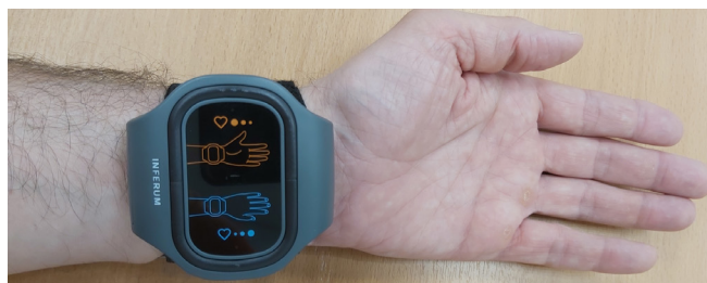
Рис. 1. Расположение электростимулятора «АВР-051» в режиме 1 – высокое артериальное давление
