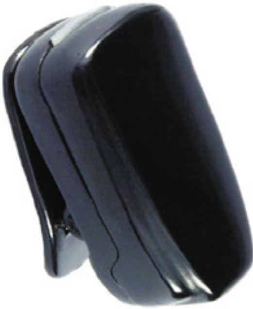
Рис. 3. Беспроводной датчик фотоплетизмографического типа (источник — http://www.heartsensor.info/we08/brochure_hrs08.pdf )
