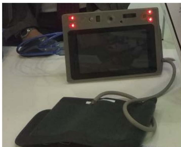
Рис. 3. а – программно-аппаратный комплекс (ПАК): 1 – веб-камера; 2 – подсветка; 3 – дальномер; 4 – микрофон; 5 – анализатор газового состава выдыхаемого воздуха; 6 – инфракрасный термометр; 7 – датчик температуры и влажности выдыхаемого воздуха; б – ПАК (А) интегрирован в единый блок с планшетным компьютером и автоматическим тонометром
