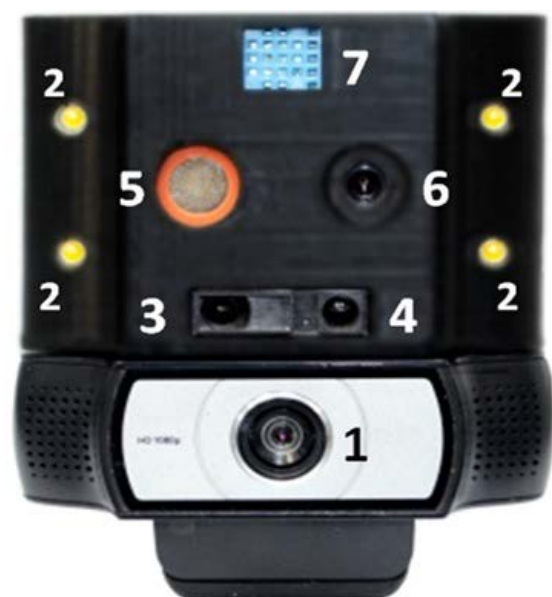
Рис. 3. а – программно-аппаратный комплекс (ПАК): 1 – веб-камера; 2 – подсветка; 3 – дальномер; 4 – микрофон; 5 – анализатор газового состава выдыхаемого воздуха; 6 – инфракрасный термометр; 7 – датчик температуры и влажности выдыхаемого воздуха; б – ПАК (А) интегрирован в единый блок с планшетным компьютером и автоматическим тонометром
